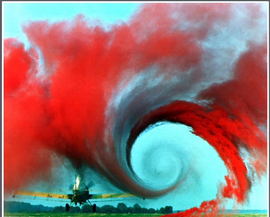
Obr. 1 Vizualizace koncového víru vznikajícího na křídle zemědělského letadla pomocí barevného kouře. Vír (resp. dvojice vírů) vzniká v důsledku rozdílu tlaku na spodní a horní straně křídla, znamená ztrátu energie a zvýšený odpor, a je tedy snaha ho u letadel konstrukčně minimalizovat. (Wake vortex study on wingtip vortices, NASA Langley Research Center, May 1990, http://lisar.larc.nasa.gov/UTILS/info.cgi?id=EL-1996-00130 )
