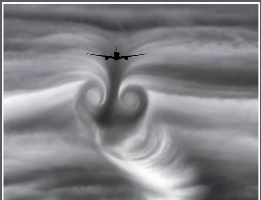
Obr. 2 Koncové víry na křídlech letadla, zmíněné již v předchozím obrázku, mají schopnost přetrvávat i několik kilometrů za letadlem a mohou nežádoucím způsobem ovlivnit aerodynamiku zejména menších letounů ještě daleko vzadu. Přirozeného zviditelnění koncových vírů je zde dosaženo díky oblačnosti těsně nad letadlem. ( http://fromthemouthofdave.blogspot.cz/2013/10/wake-turbulence.html )
