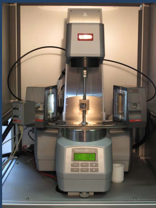
Rotační reometr MCR 501 (Anton Paar) vybavený pecí s kamerou pro měření polymerních tavenin do teplot až 450 °C
