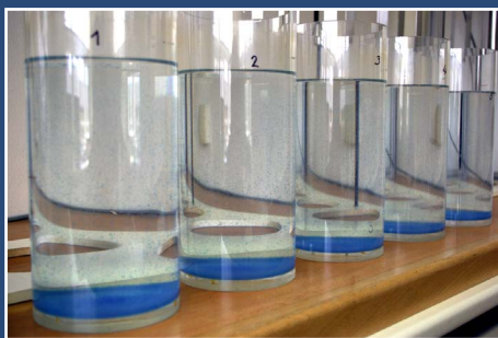
Koagulační pokus s vodou obsahující proteinové AOM – modré agregáty vznikají interakcí proteinů s hliníovým koagulačním činidlem
