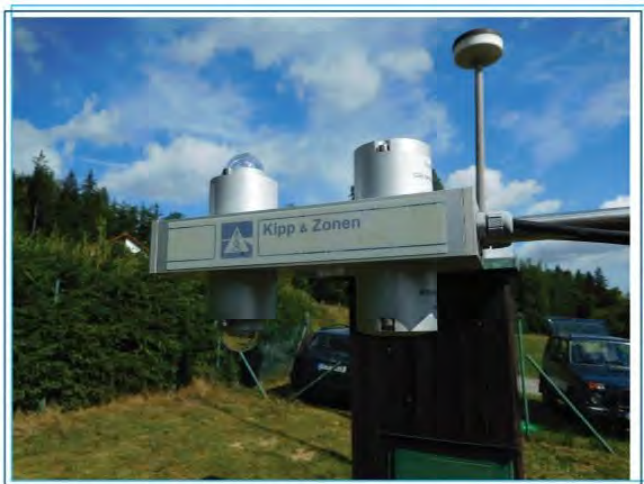
Čidla pro měření radiace krátkovlnné – sluneční (vlevo) a dlouhovlnné – vycházející ze Země (vpravo). Obě čidla jsou párová, tak aby měřila přicházející i odraženou složku radiace.
